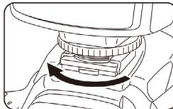
5. 闪光灯脚内的安全销钉在锁定环锁紧时会自动与相机热靴内的安全孔耦合在一起。
